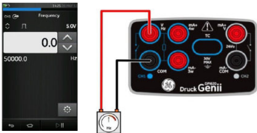
2-18 сурет. В мысалы, CH1 аспабымен генерациялау жиілігі (диапазоны 0—50 кГц)
