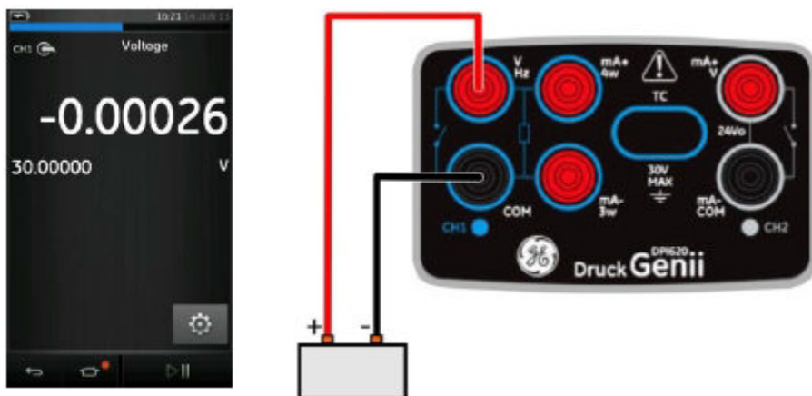
2-11 сурет. CH1-де тұрақты токтың кернеуін не тұрақты токтың мВ өлшеу. Диапазоны ±30 В
