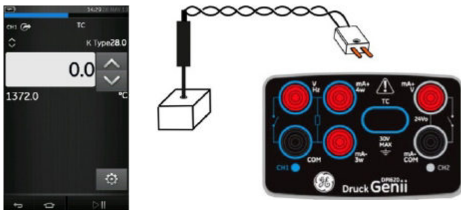
2-22 сурет. CH1 аспабымен 21К-типіндегі терможұбының температурасын өлшеу (-270 және 1372 °C аралығындағы диапазоны)
