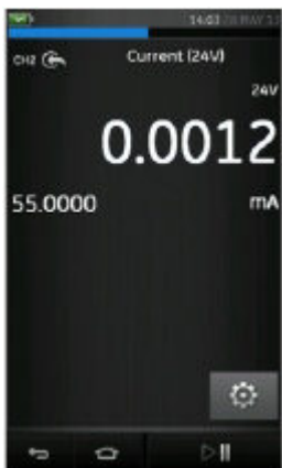
2-16 сурет. CH2 аспабымен ішкі қорек контурындағы тоқты өлшеу (диапазоны: \pm 55 \text{ mA} )
