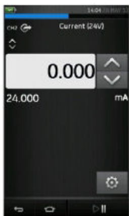
2-15 сурет. CH2 аспабымен ішкі қорек контурындағы тоқты генерациялау (диапазоны: 0—24 mA)
