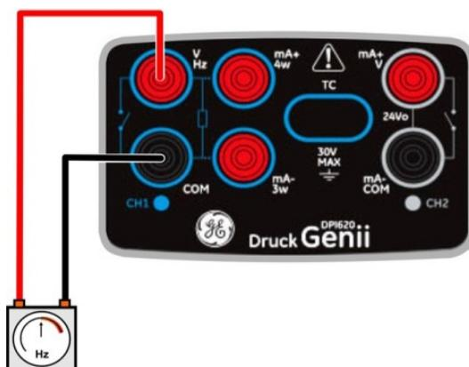
Рисунок 2-18. Пример В, частота генерации CH1 (диапазон 0—50 кГц)
