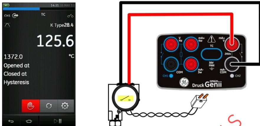
**Рисунок 2-23. Генерация сигналов термопарой на CH1
