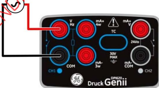
Рисунок 2-12. Измерение напряжения перемен. тока или мВ перемен. тока на CH1. Диапазон  $\pm 20$  среднеквадратических вольт
