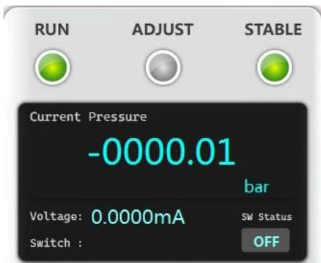
6) После сообщения устройства о его стабилизации введите данные манометра, который необходимо проверить, в форму «displayed value before tapping» (отображаемое значение перед подключением);
