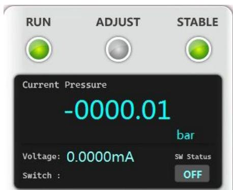
7) Нажмите «test automatically» (автоматическое испытание), давление прибора автоматически повысится, и он автоматически запишет фактическое выходное значение испытываемого преобразователя, затем отобразится следующий интерфейс:
