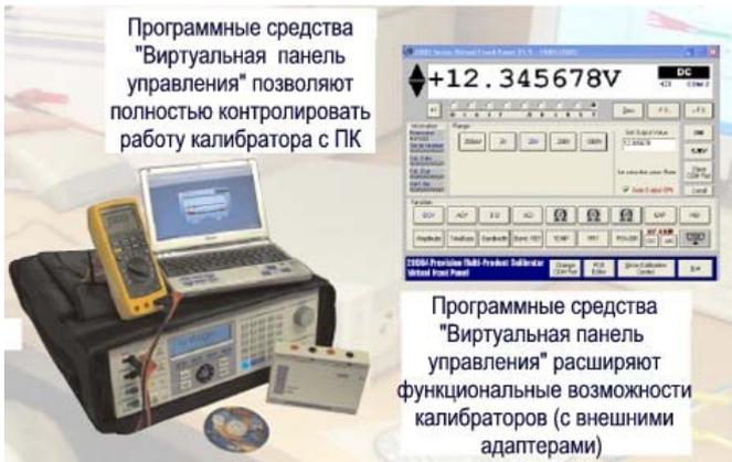
Разработанные и рекомендуемые фирмой Transmille, программные средства «Virtual Front Panel (VPF) - виртуальная панель управления» и средства автоматизации калибровки ProCal и управления работой метрологической службы ProCal-Track служат для облегчения работы и повышения производительности труда поверителей. Особенности и возможности программных средств ProCal и ProCal-Track рассмотрены в отдельной брошюре
